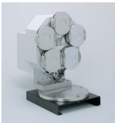
Рис. 3.34. 5-позиційний автоматичний замінювач зразків ASC-1001
