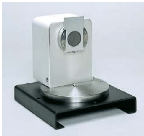
Рис. 3.33. Столик для обертання зразка RS-1001
