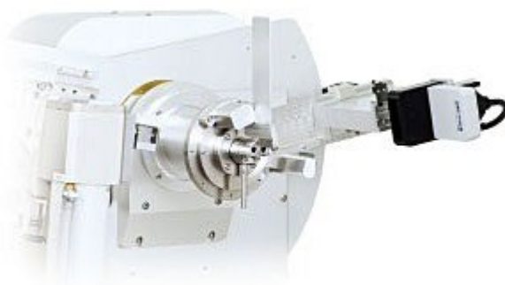
Рис. 3.32. зовнішній вигляд мультиполосного кремнієвого детектора OneSight
