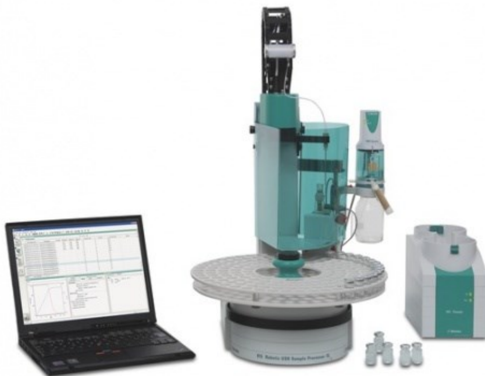
Рис. 2.13. Зовнішній вигляд автоматизованої установки для проведення кулонометричного титрування марки МАТі 4
