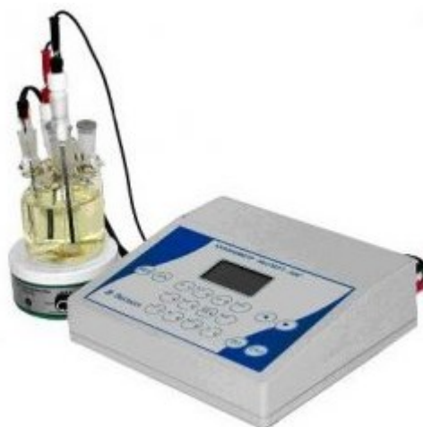
Рис. 2.14. Зовнішній вигляд кулонометра марки «Експерт-006»
