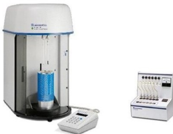
Рис. 6.8. Зображення аналізатора GEMINI та станції дегазації
