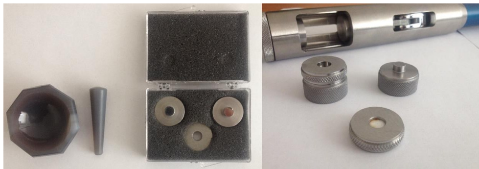
Рис. 5.17. Агатову ступку, прес-форму та ручний прес для виготовлення таблеток із калій броміду
