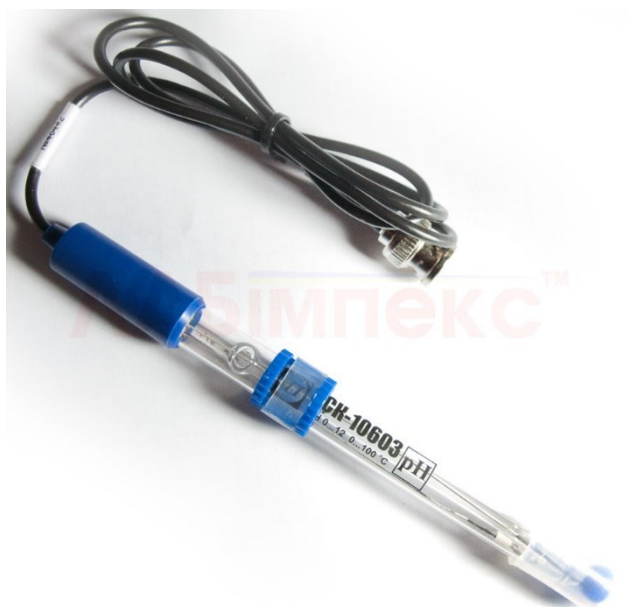
Рис. 2.4. Зовнішній вигляд скляного електрода
