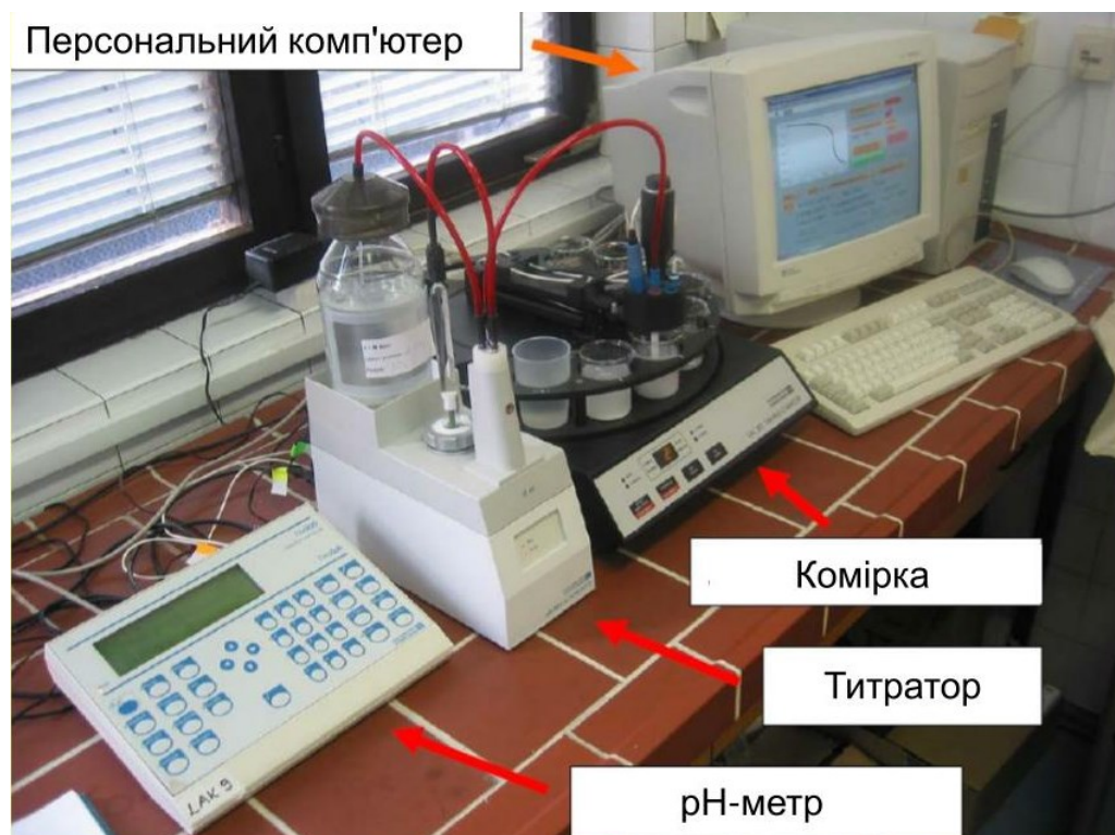
Рис. 2.9. Зовнішній вигляд сучасного титратора з автоматизованою системою управління та зчитування показань
