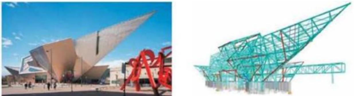
Рисунок 1.8 – BIM сталевих каркасу та фасад Музею мистецтв у Денвері, США, арх. бюро D. Libeskind, 2006 р.
