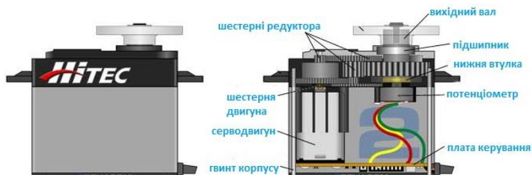
Рис. 2.5. – Внутрішня будова серводвигуна
