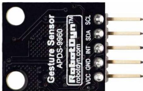
Рис. 3.3. – Виходи датчика кольору RobotDyn APDS-9960
