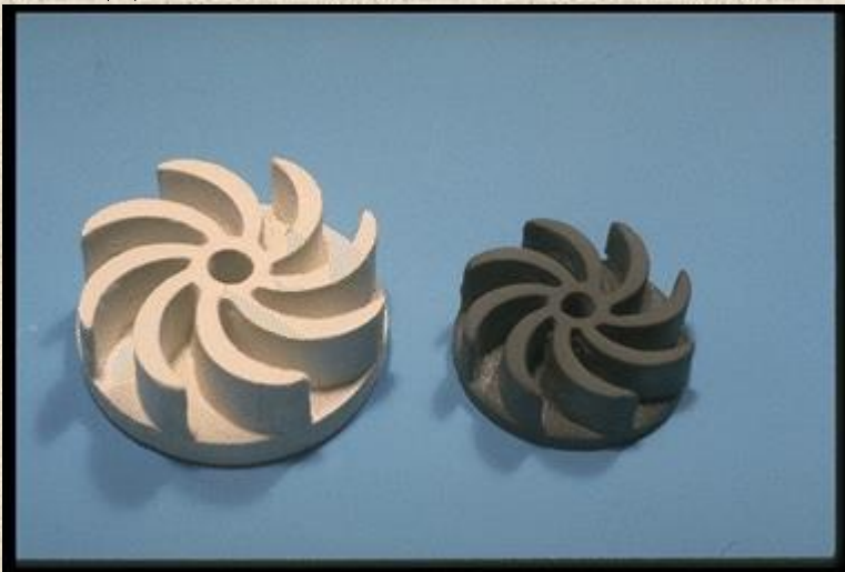
Структурна частина глинозему до і після спікання
