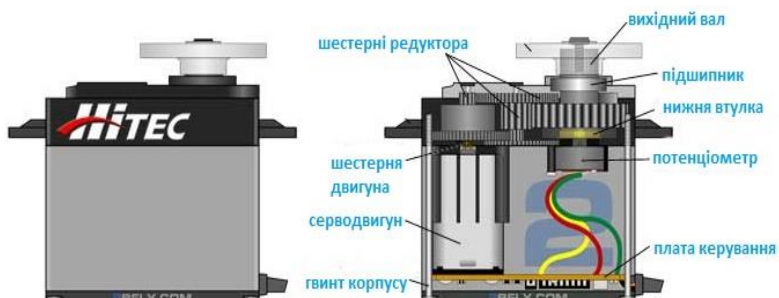
Рис. 2.5. – Внутрішня будова серводвигуна
