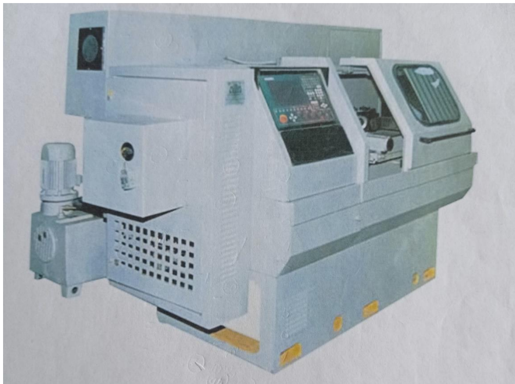
Рис. 1.1. Токарно-револьверний верстат моделі 1B340Φ30 з оперативною системою (ОС) ЧПУ Електроніка НЦ-31 виробництва БВБЗ “Комсомолец” (за часів СРСР)
