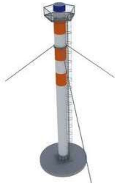
Рисунок 4.1 – Зовнішній вигляд металевої димової труби котельні, що підкріплена тязами (а) та попереднє креслення відтяжки (б)
