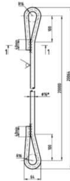
Рисунок 4.1 – Зовнішній вигляд металевої димової труби котельні, що підкріплена тязами (а) та попереднє креслення відтяжки (б)
