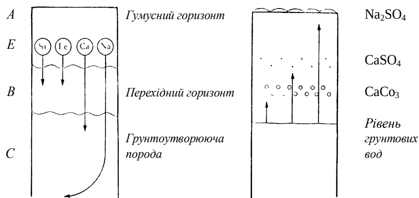
Рис. 2. Схема формування (будови) профілю автоморфних (1) і гідроморфних ґрунтів (2).
