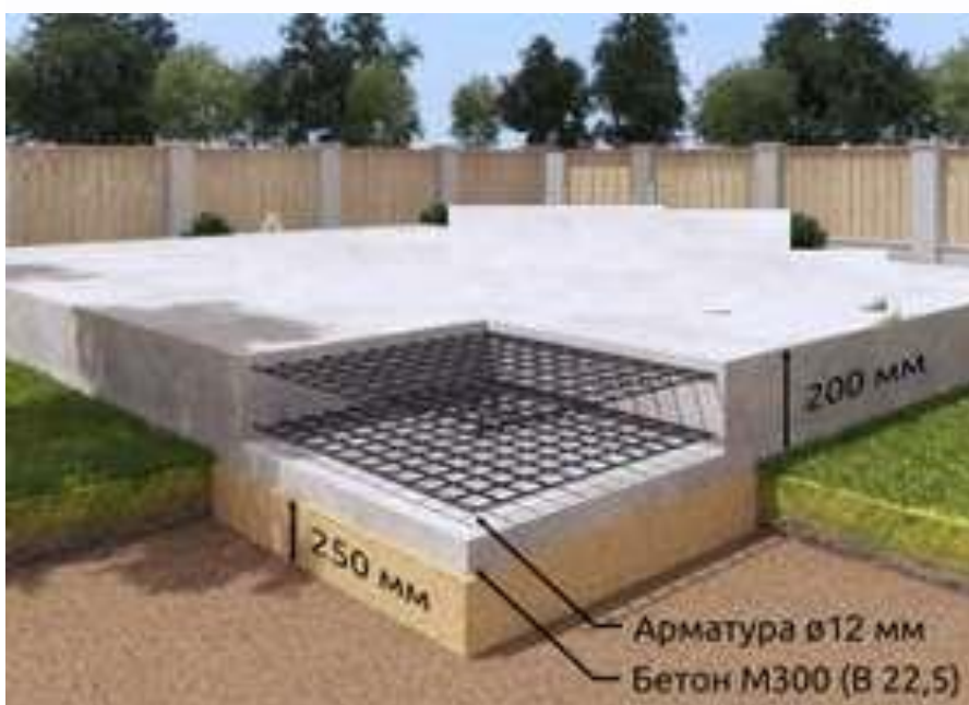
Рис. 8.9. Приклад облаштування монолітного фундаменту
