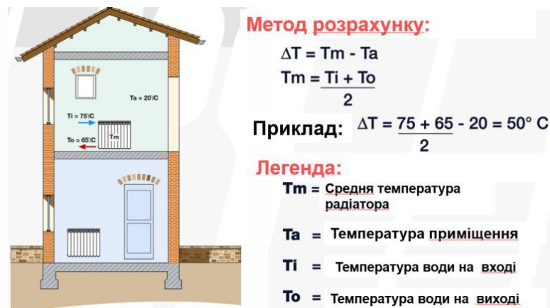
Рис. 5.1 Методика розрахунку температурного напору
