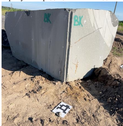
Рис. 1 Закладення опорної точки GCP
