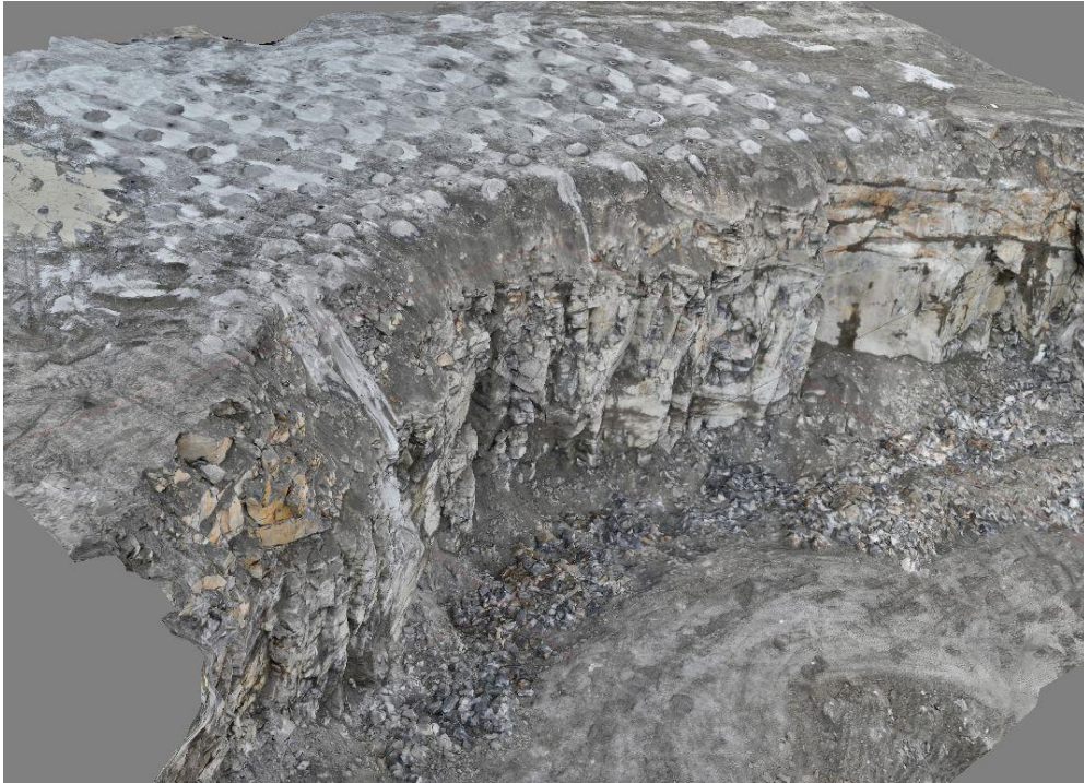
Рис. 3. Модель блока з фактичним розташування свердловин в паспорті буровибухових робіт на Березівському-1 родовищі граніту
