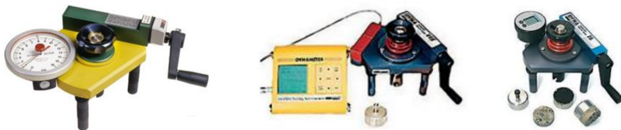
Рис.3.2. Адгезіометр в різних конструкційних виконаннях
