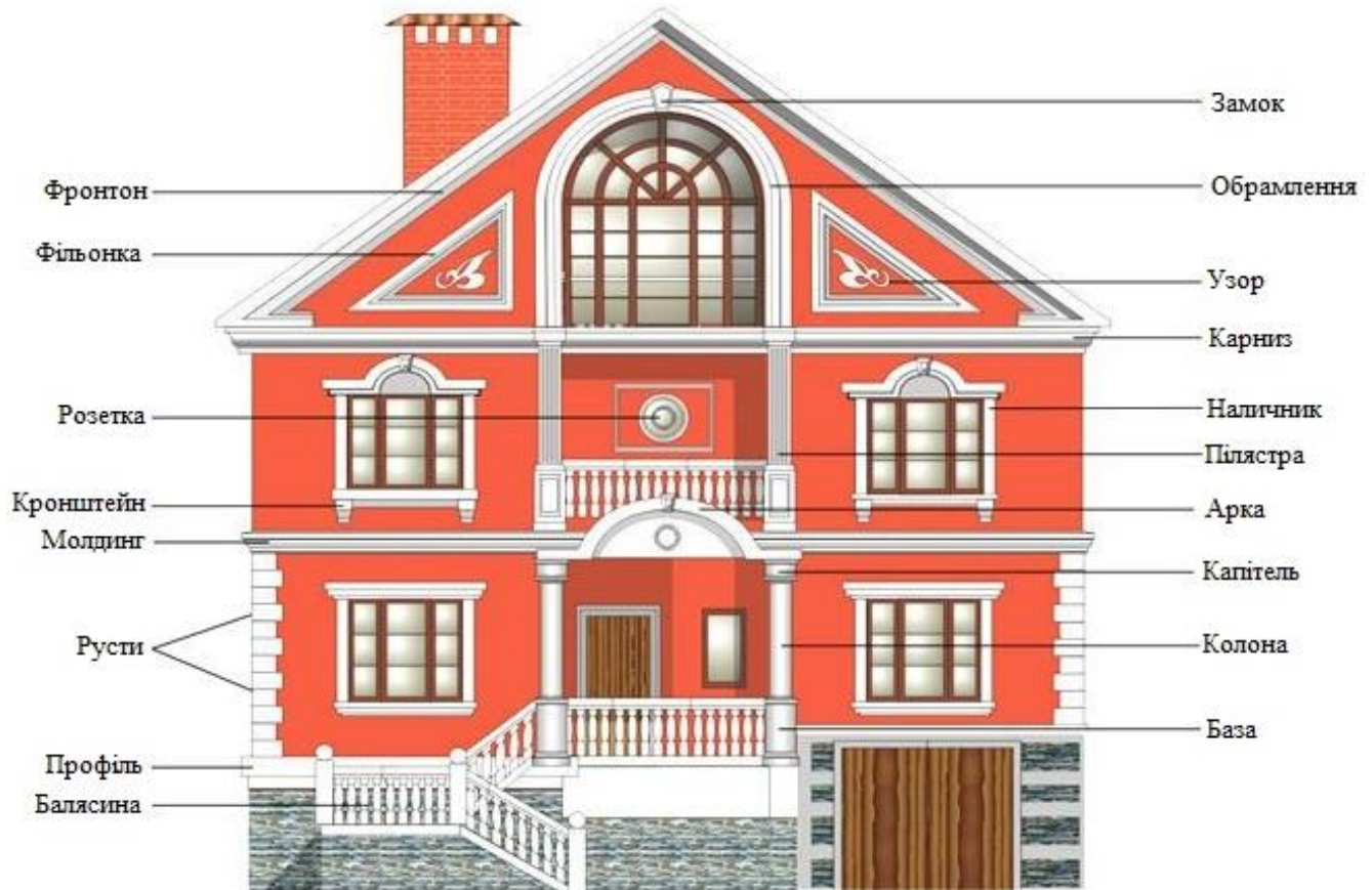
Рис.5.1. Елементи фасаду будівлі
