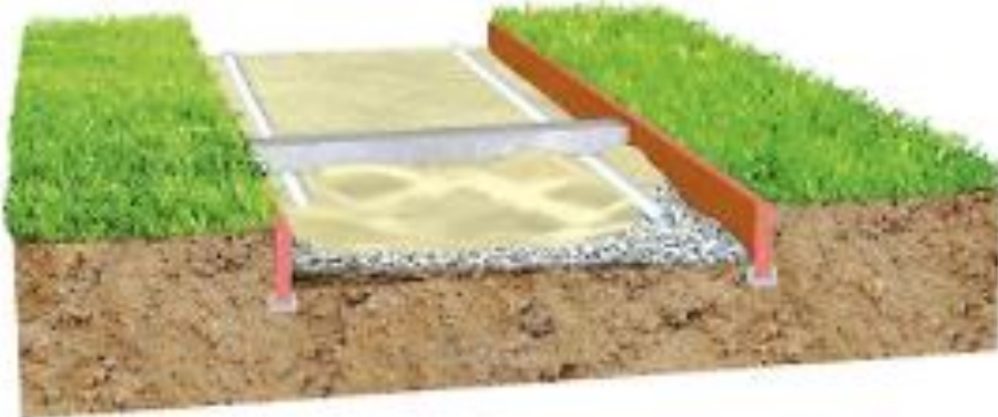
Рис. 7.5. Приклад облаштованого шару підсіпки
