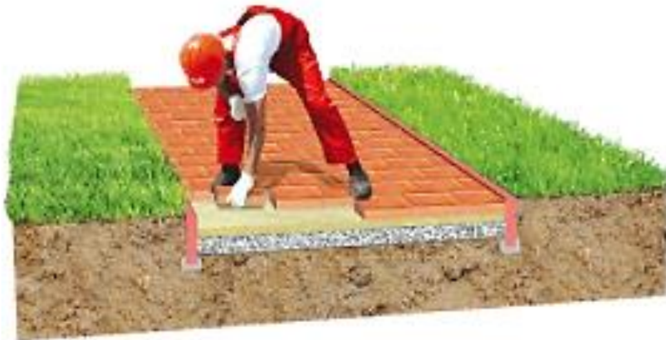
Рис. 7.6. Приклад процесу укладання бруківки від краю до центру
