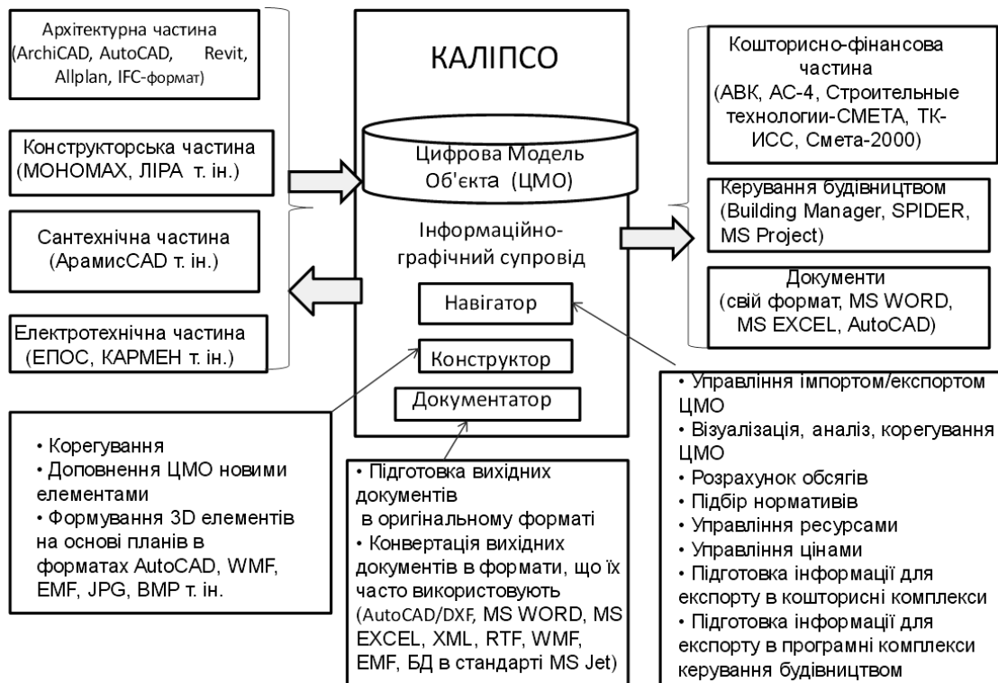
Рисунок 3.11 – Схема наповнення та функціонування технології інтегрованої лінії проектування КАЛІПСО
