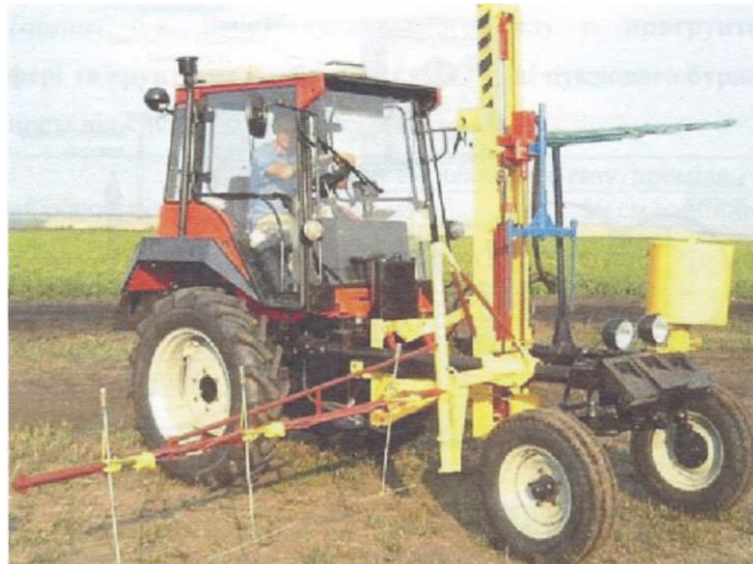
Мал. 2. Мобільний діагностичний агрегат МДА-СШ 30
