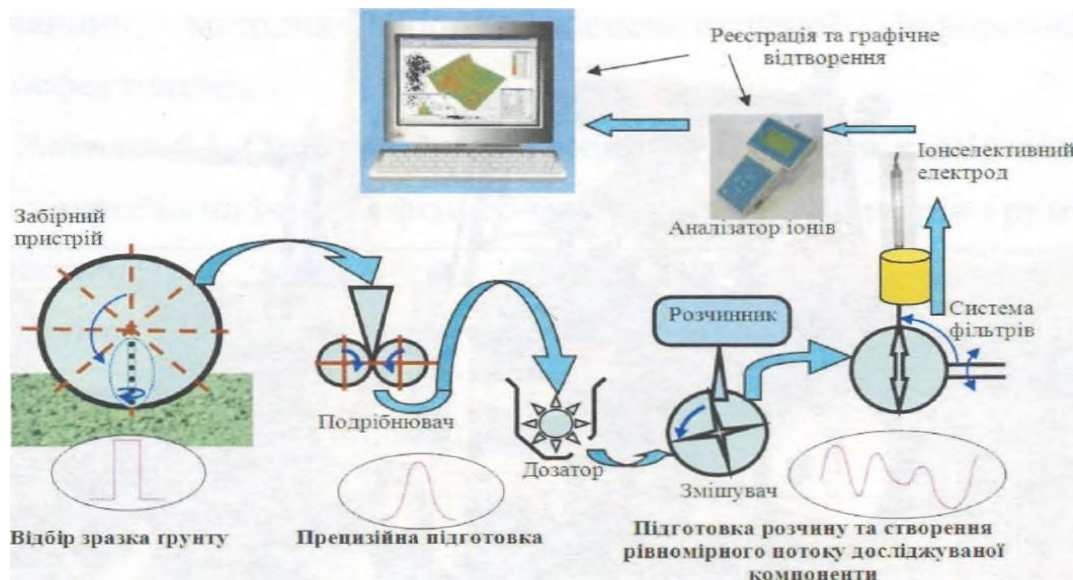
Мал. Схема функціонування технологічного модуля для вимірювання рН ґрунту
