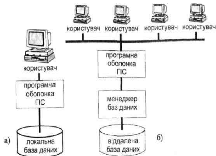
Рис. 3.5. Схеми організації роботи з базами даних при різних варіантах архітектури ГІС: а) локальна база даних; б) віддалена база даних.
