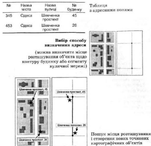
Рисунок 5.7 – Геокодування місця розташування будинків за адресним прив'язуванням в базі даних формату StreetMap
