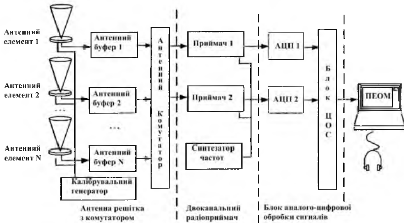
Рис. 4.1 – Структурна схема багатоканального кореляційно-інтерферометричного радіопеленгатора
