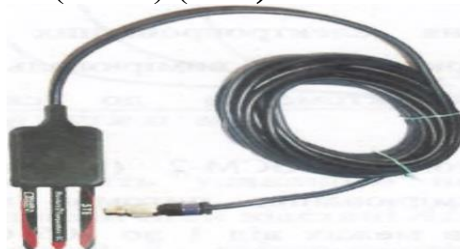
Датчик SMTE вимірювання електричної провідності і температури ґрунту
