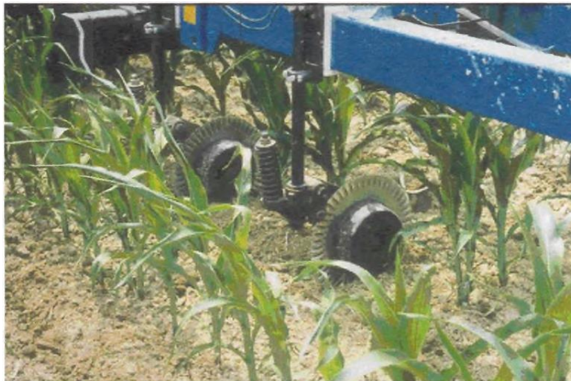
Парні диски-електроди системи "Soil Doctor" для зондування ґрунту
