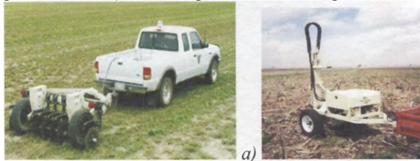
Моделі Veris 3100 - а) та Veris Profiler — б) в роботі
