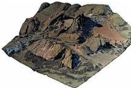
Рис7.2. - Хмара точок породжена гео-даними парку Ред Рокс, які отримані з дрона.
