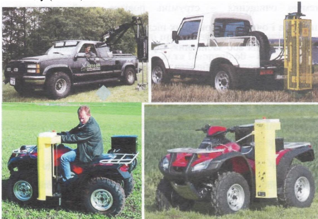
Мал. 4. Приклади виконання автоматизованих систем відбору зразків ґрунту
