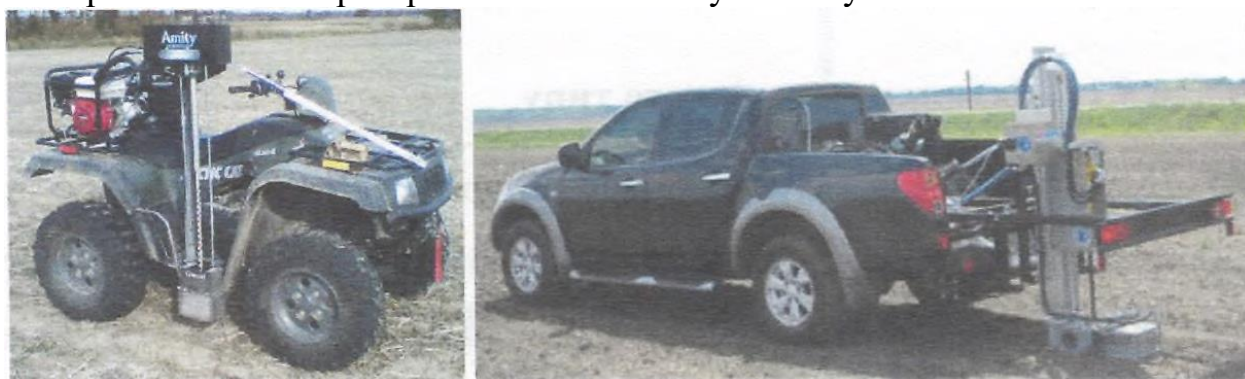
Мал. 5. Автоматизовані пробовідбірники зразків ґрунту а) Amity A2450, б) Duorob 60
