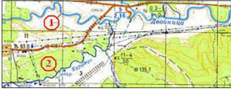
Рисунок 6.2 – Фрагмент топографічної карти, на якій за допомогою лінійних знаків подаються дороги, лінії електропередач, водотоки: 1 – річки шириною від 5 м до 30 м; 2 – річки та струмки шириною до 5 м (зображення з сайту http://www.geoguide.com.ua )
