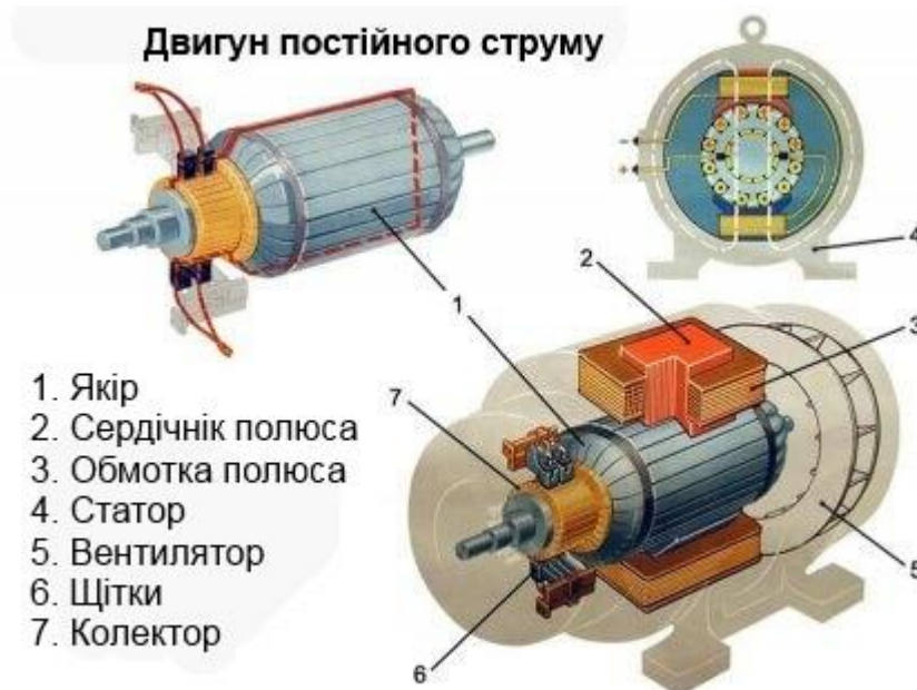
Рис. 3.2. Основні елементи двигуна постійного струму
