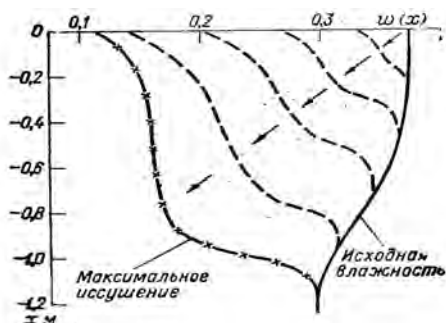
Рис. 2.22. Висушування ґрунту за період вегетації (схема).
