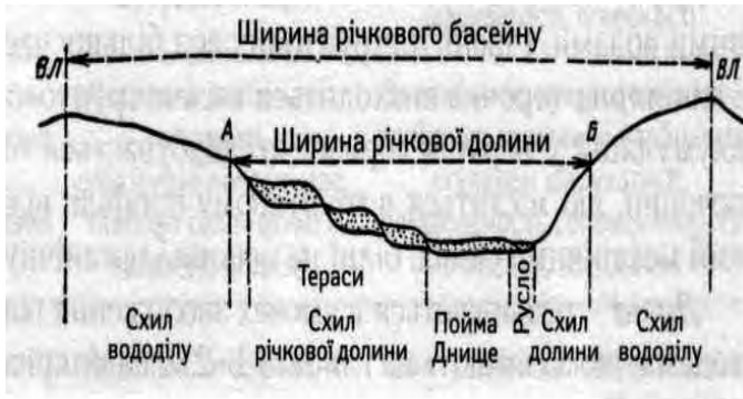
Рис. 3.13. Поперечний переріз басейну і долини ріки (М. П.Толстой, 1991): ВЛ - лінія водо розділу
