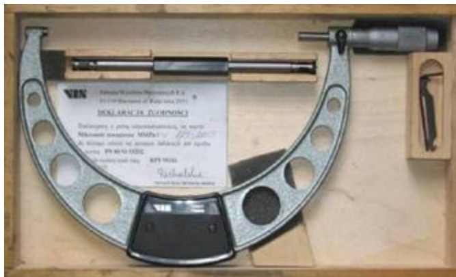
Рис.4.2 - Мікрометр з круговою шкалою для зовнішніх вимірювань і діапазоном вимірювання 175-200 мм, із ціною поділки 0,01 мм.
