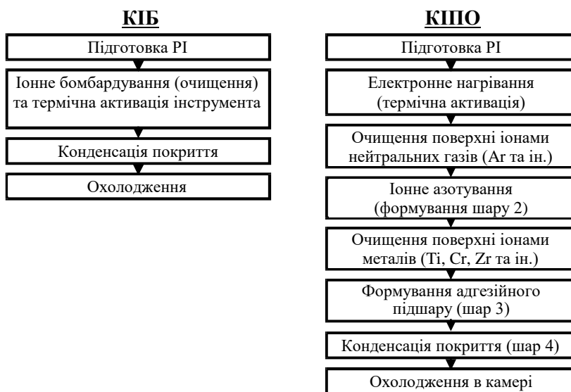
Рис. 4. Блок-схема технологічного процесу комплексної іонно-плазмової обробки (КІПО) різального інструмента
