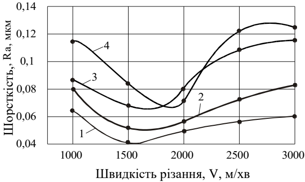
Рис. 1. Вплив інструментального матеріалу на шорсткість. Умови: 1 – природний алмаз; 2 – синтетичний алмаз; 3 – Ельбор-Р; 4 – Гексаніт-Р
