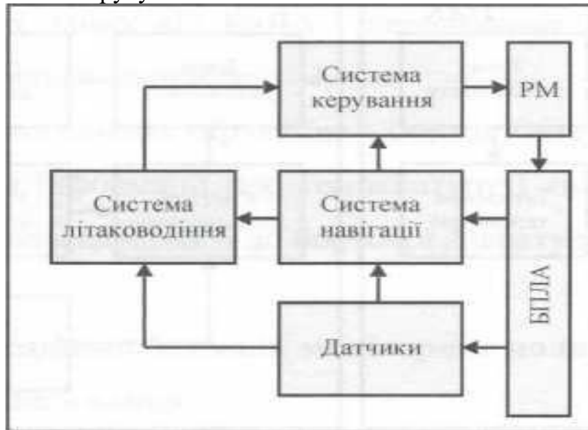
Мал. 2. Функціональна схема керування автоматичним режимом польоту.
