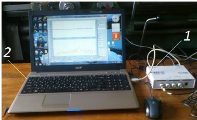
Рис. 5.3. Дослідна установка для запису вібраційного сигналу. 1 – вимірювальна система для віброакустичних досліджень E20-10 виробництва L-CARD. 2 – ПЕОМ з спеціалізованим програмним забезпечення LGraph.
