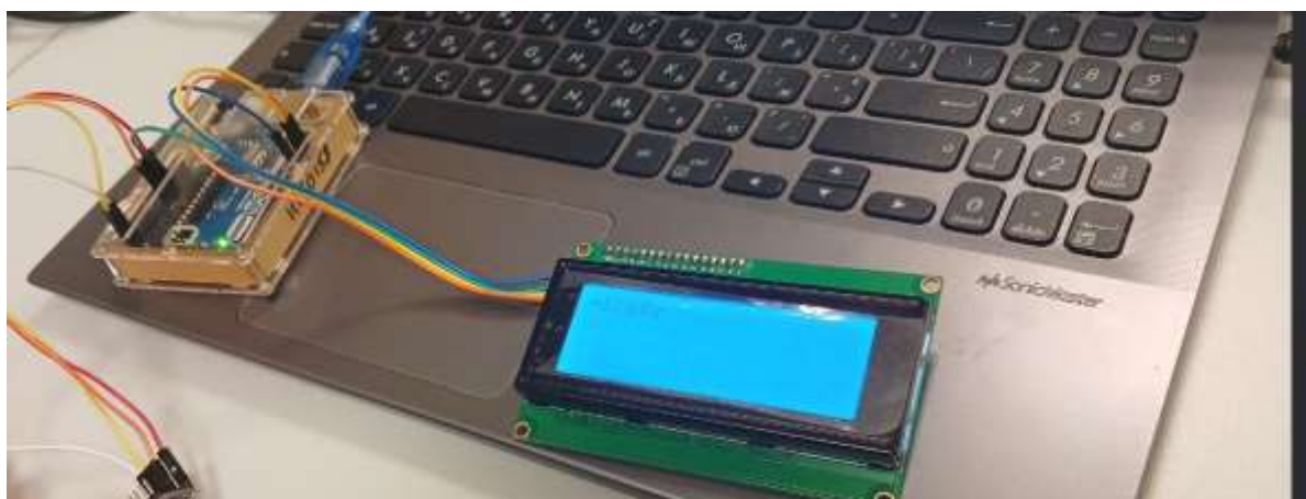
Рис.5.7 Підключення дисплею і гіроскопа до Arduino UNO
