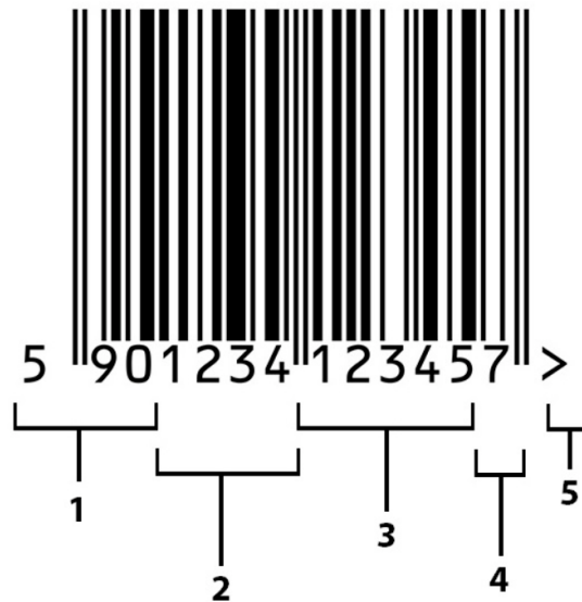
Рис. 2.1. Приклад штрихового коду з розшифровкою груп цифр 1 – Код країни; 2 – Код виробника; 3 – Код товару; 4 – Контрольна цифра; 5 – Знак товару, виготовленого за ліцензією.
