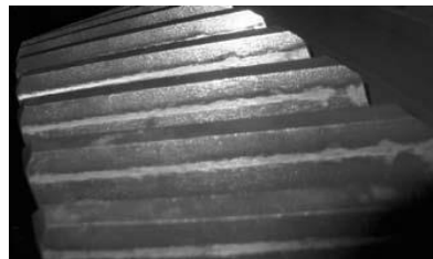
Рис. 3.12. Руйнування поверхні зубів від втоми
