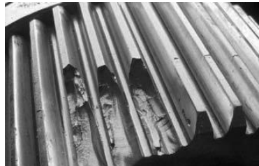
Рис. 3.11. Руйнування зубів від великого перевантаження статичної або ударної дії
