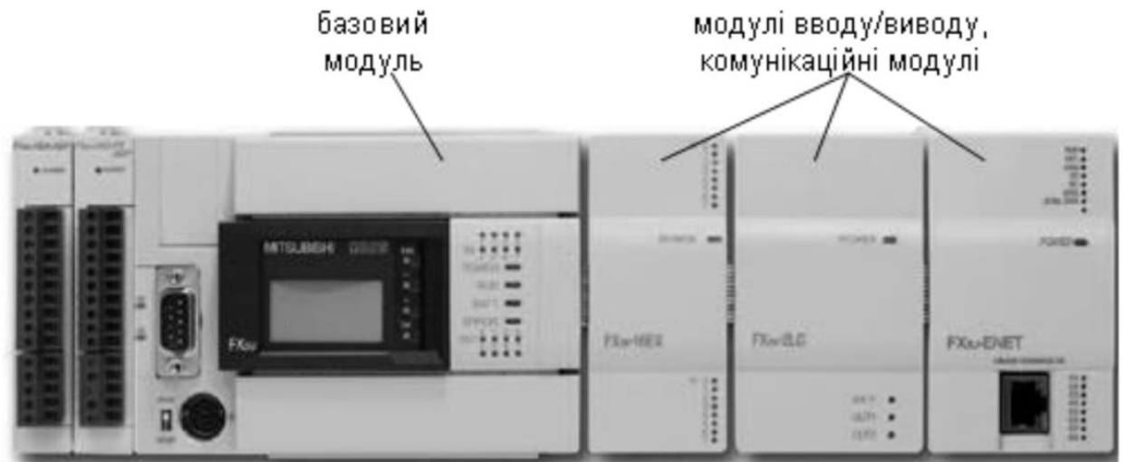
Рис. 1.3. Приклад компактного ПЛК з можливістю нарощення додатковими модулями
