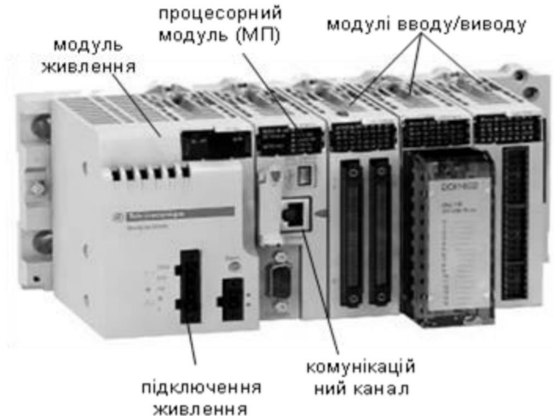
Рис. 1.4. Приклад ПЛК модульного типу
