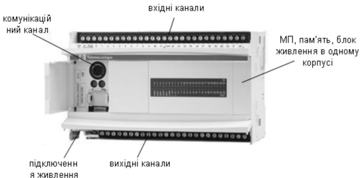
Рис. 1.2. Приклад ПЛК у моноблочному виконанні
