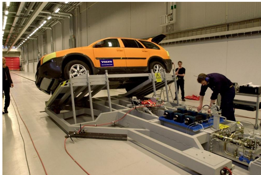
Рис. 5.11. - Випробування автомобіля на статичну стійкість
