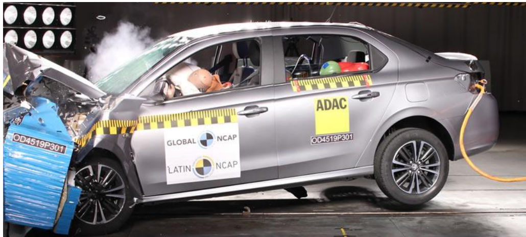
Рис. 5.10. - Випробування на фронтальне зіткнення з перешкодою, що деформується
