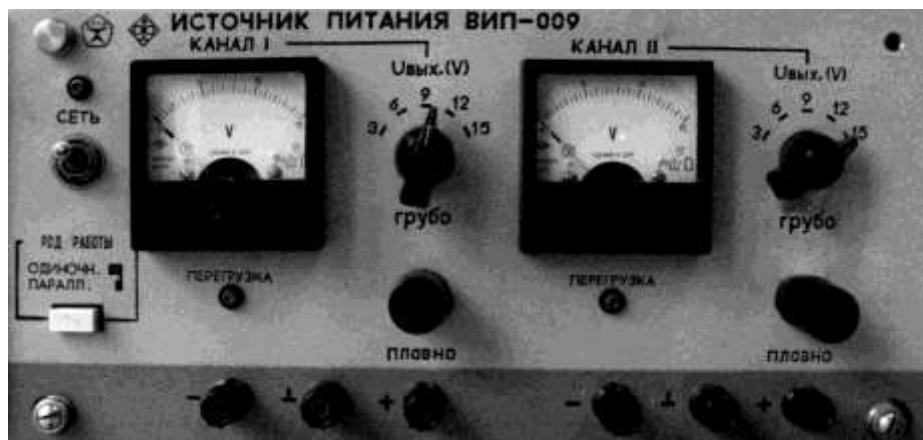
Рис. 1.2 – Кероване джерело постійної напруги ВІП-009
