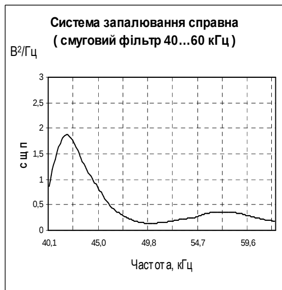
Рисунок 4.8 – Вплив несправностей системи запалювання на окремі діапазони частотного спектра
