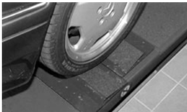
Рисунок 5.16 – Стенд для діагностування кутів встановлення керованих коліс (справа) та виконання на підйомнику (зліва)
