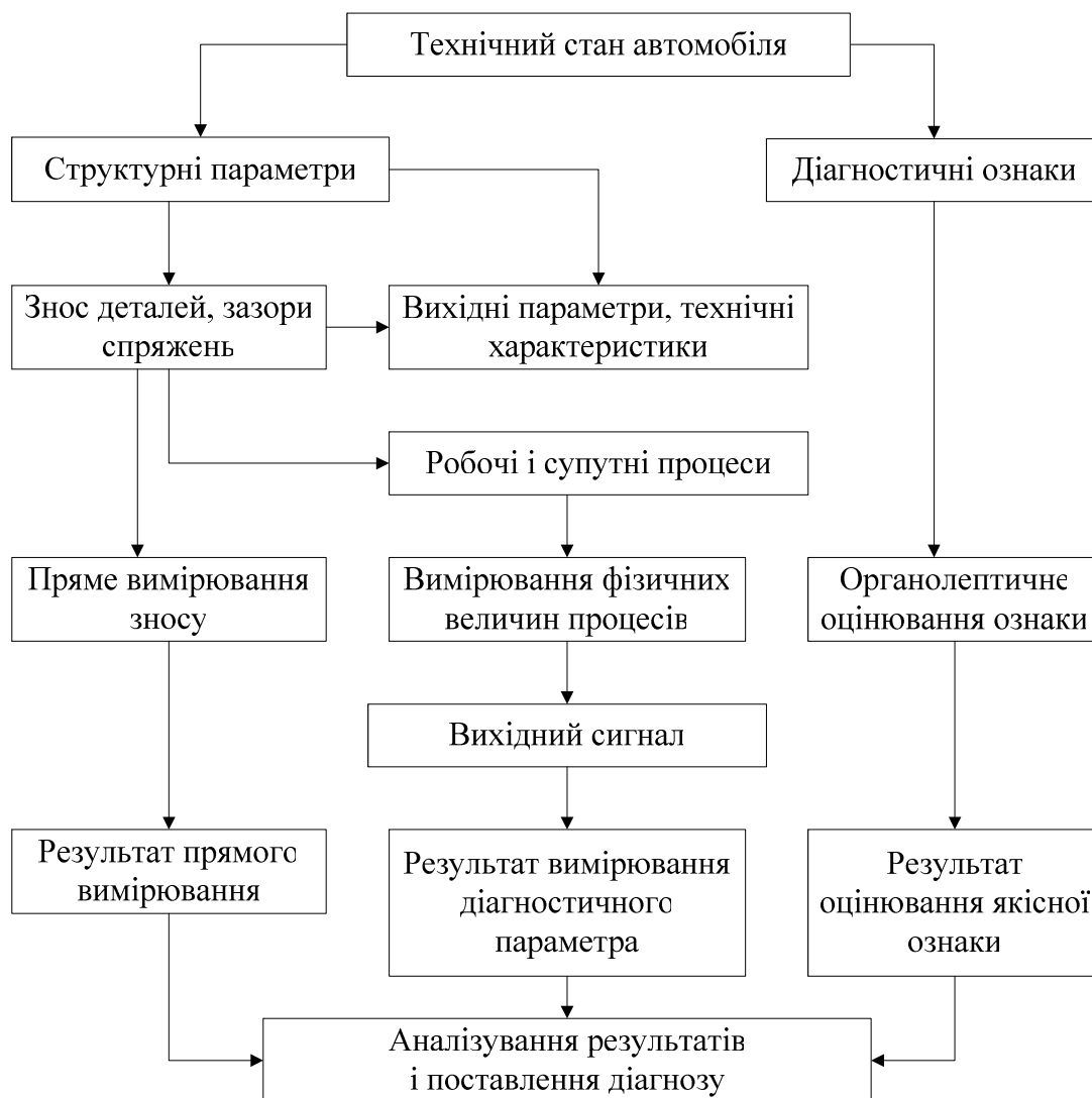
Рисунок 5.1 – Схема застосування технологічних методів діагностування
