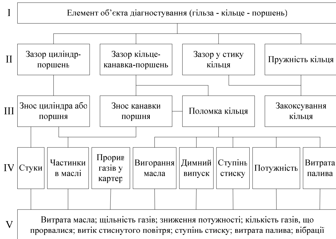
Рисунок 2.9 – Причинно-наслідкова діагностична модель поршневої групи автомобільного двигуна
