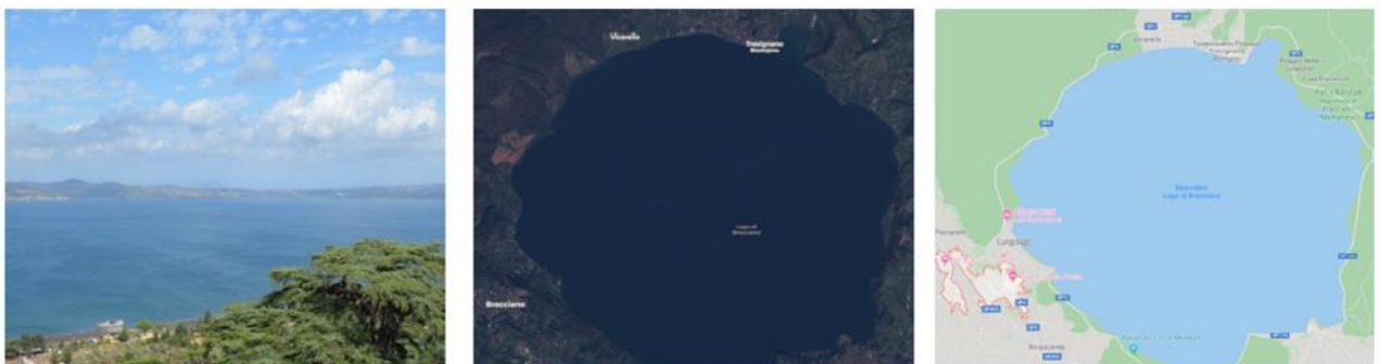
Рис. 4. 12 – Формати представлення географічних об'єктів: реальний світ (а), космічний знімок (растр) (б), вектор (точки, лінії, полігони) (в)
