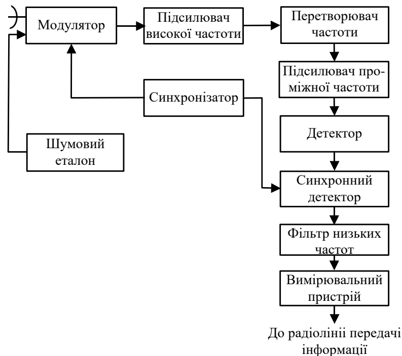
Рис. 6.7 – Структурна схема радіометра модуляційного типу
