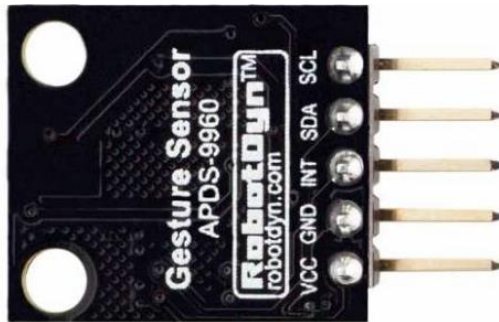
Рис. 3.3. – Виходи датчика кольору RobotDyn APDS-9960
