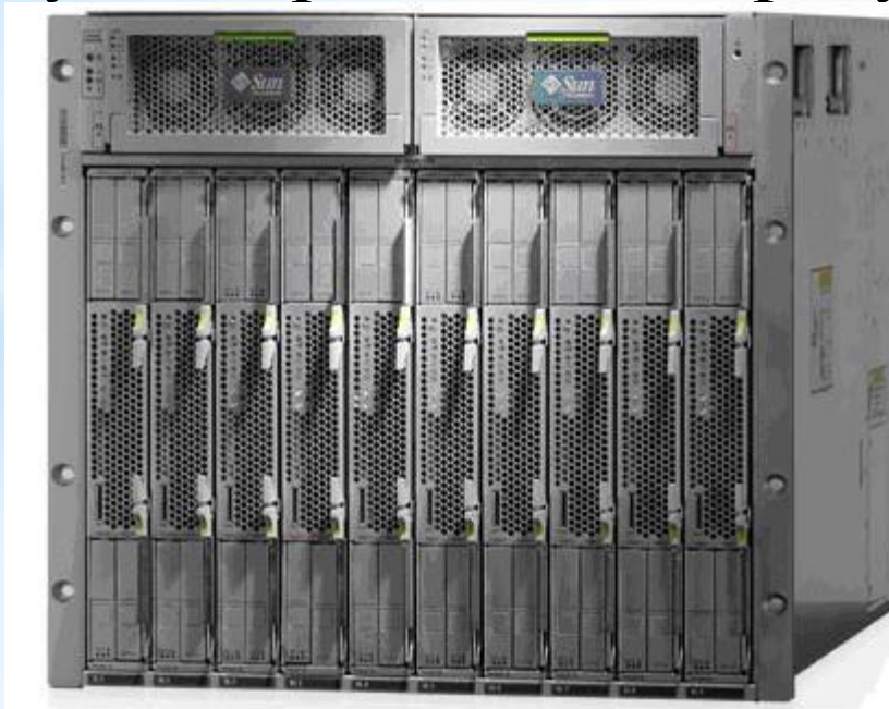
Рисунок 5 – Типове 10U шасі для 10 Blade-серверів
