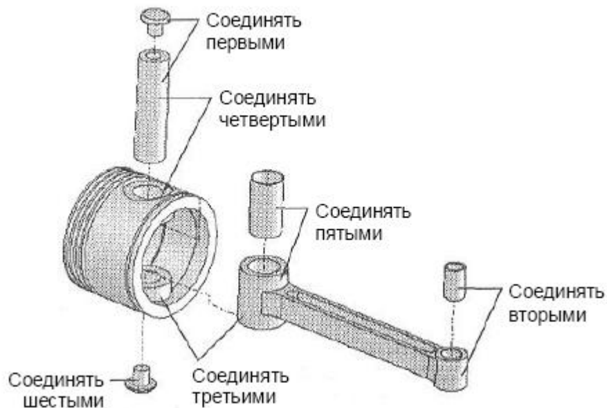
Рис. 7.3.5. Рекомендований порядок збірки
