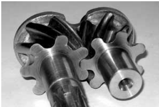
Рис. 10.10. Загальний вигляд дозаполюсної передачі
