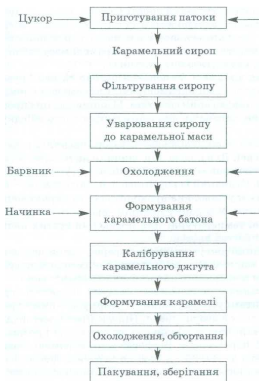
Рис. 7.1. Принципово-технологічна схема виготовлення карамелі
