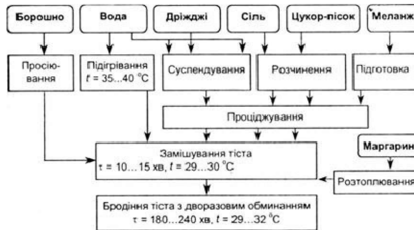
Рис. 5.1. Технологічна схема дріжджового безопарного тіста
