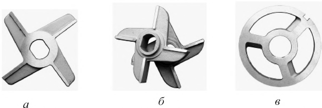
Рисунок 8.25 – Ножі м'ясорубки МИМ-300: а – ніж двосторонній без бурта; б – ніж двосторонній; в – решітка підрізна
