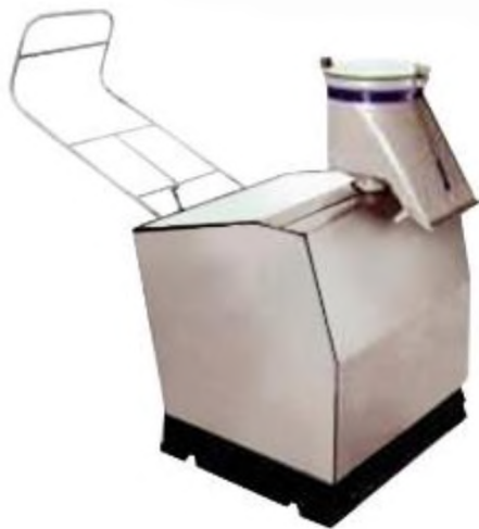
Рисунок 3.8 – Загальний вигляд машини для просіювання борошна МПМ-800: 1 – станина; 2 – рама підйомна; 3 – кришка робочої камери; 4 – труба шнека; 5 – рукав розвантажувальний; 6 – бункер завантажувальний; 7 – електродвигун
