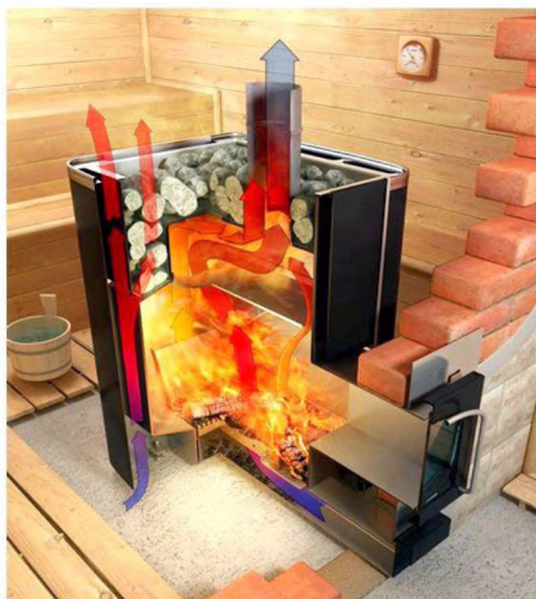
Схема принципу дії дров'яної печі-кам'янки
