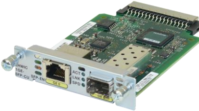
г) Cisco EHWC-1GE-SFP-CU (1 інтерфейс Gigabit Ethernet, рознім RJ-45, 1 інтерфейс Gigabit Ethernet для змінного модуля SFP)
