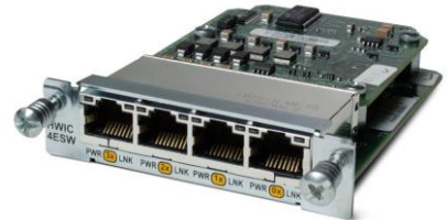
д) Cisco HWIC-4ESW (4 інтерфейси Fast Ethernet, рознім RJ-45)
