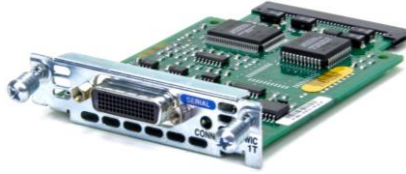
а) Cisco WIC-1T (последовний інтерфейс, рознім V.35)
