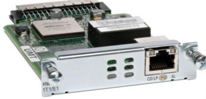
б) Cisco HWIC-1T1/E1 (последовний інтерфейс, рознім RJ-48)
