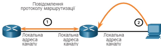
Рис.4. Можливості використання локальної IPv6-адреси каналу
